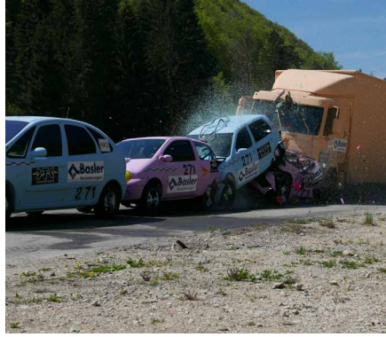
Crash de véhicule complet avec un camion contre une colonne à l'arrêt
