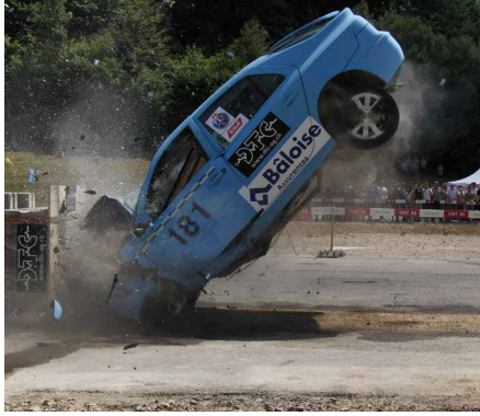
Crash de véhicule complet contre une barrière fixe
