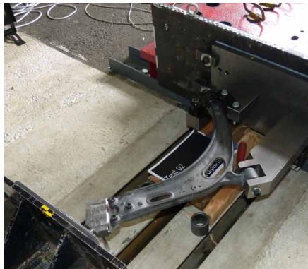
Energieaufnahme eines Querlenkers
