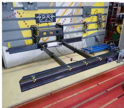
Prüfung eines Unterfahrschutzes
