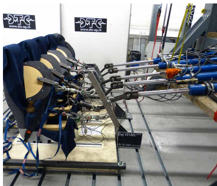
Quasistatischer Zugversuch eines Schulbus-sitzes
