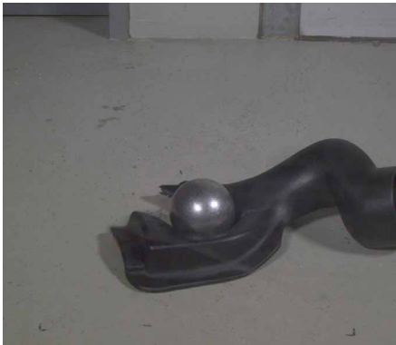
Kugelfallversuch an einer Ansaugluftherhöhung
