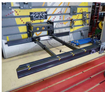
Prüfung eines Unterfahrschutzes
