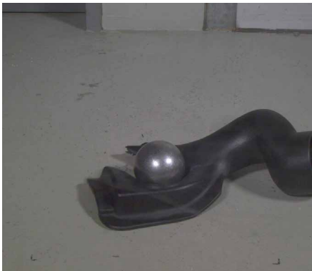
Kugelfallversuch an einer Ansaugluftherhöhung
