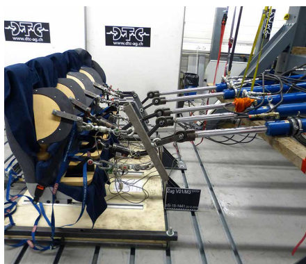
Quasistatischer Zugversuch eines Schulbus-sitzes
