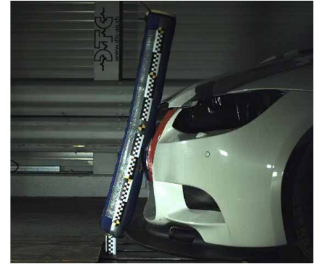
Fussgängerschutz mit Beinimpaktor
