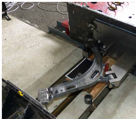
Energieaufnahme eines Querlenkers
