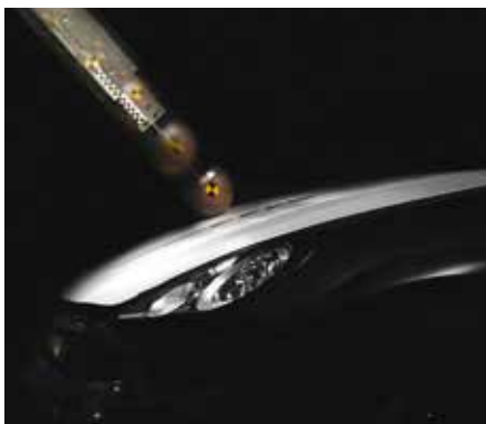
Corps d'impact de tête en vol libre peu de temps avant l'impact
