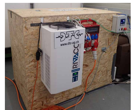
Essai de vibration dans une chambre climatique
