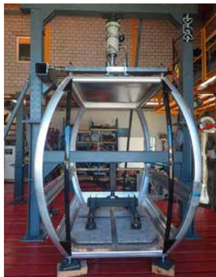
Test d'endurance de cabine de téléphérique
