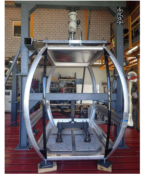
Test d'endurance de cabine de téléphérique
