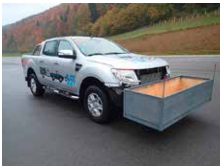
Abänderungsprüfung einer Auflastung
