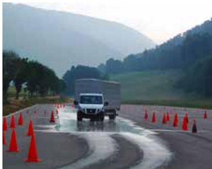
Bremsen / Ausweichen, ESC Überprüfung
