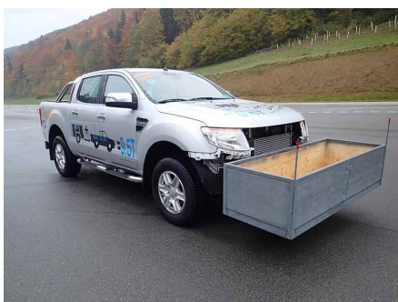
Abänderungsprüfung einer Auflastung
