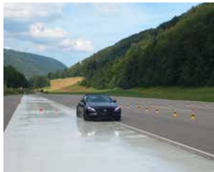
Fahrdynamikuntersuchung: \mu -Split Bremsung
