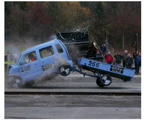
Suzuki Wagon mit Anhänger, mit 57 km/h gegen Block, Thema Ladungssicherung
