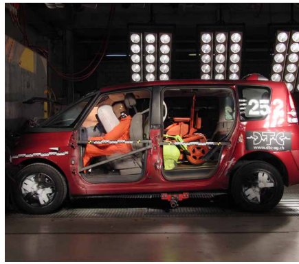
Renault Espace mit 50 km/h gegen Block, Thema Ladungssicherung
