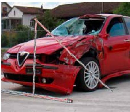
Dommages au véhicule après collision avec un véhicule circulant en sens inverse
