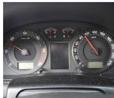
Compteurs bloqués avec l'affichage de la vitesse et du régime
