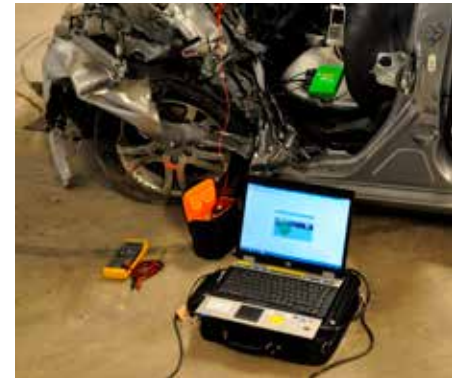
Auslesung EDR im Steuergerät (Bosch CDR)
