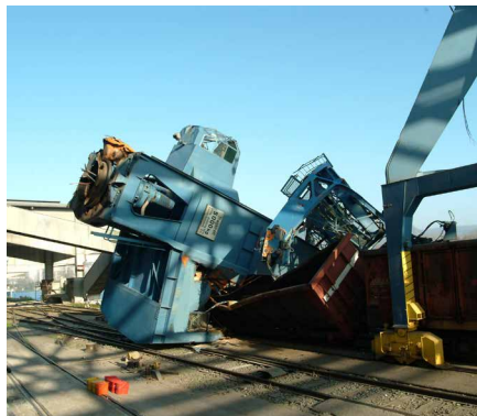
Abgebrochener Hafenkran nach Durchsagung der Turmsäule
