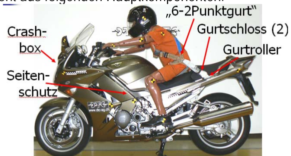
Bild 4: Sicherheitsgurt und Komponenten des Motorrad-Rückhaltesystems
