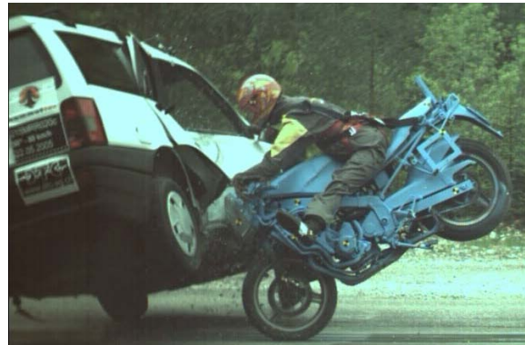
Bild 7: Motorradfahrer wird auf dem Motorrad wirkungsvoll gehalten
