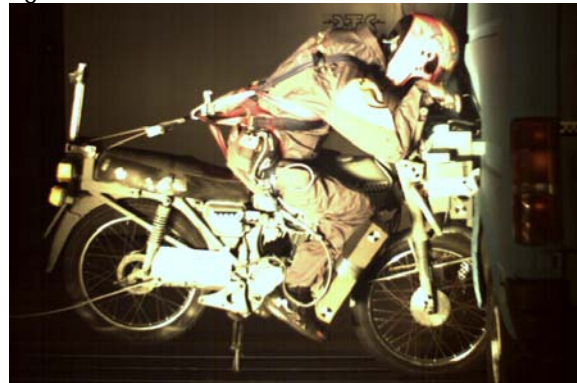
Bild 5: Crash nach 100 ms, die Geschwindigkeit ist nahezu abgebaut
