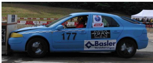
Abb. 27: Aufprall mit 14 km/h gegen eine starre Wand
