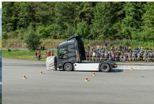
Abb. 49: Fahrdemonstration AEBS Bremsung (aktive Sicherheit)
