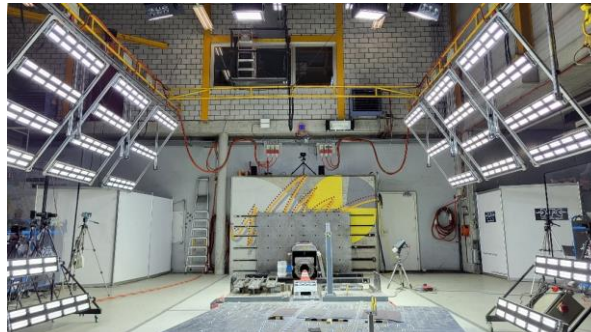
Abb. 23: Crashhalle mit LED-Scheinwerfern (neu)
