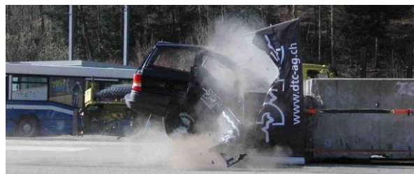
Abb. 28: Aufprall mit 200 km/h gegen eine starre Wand
