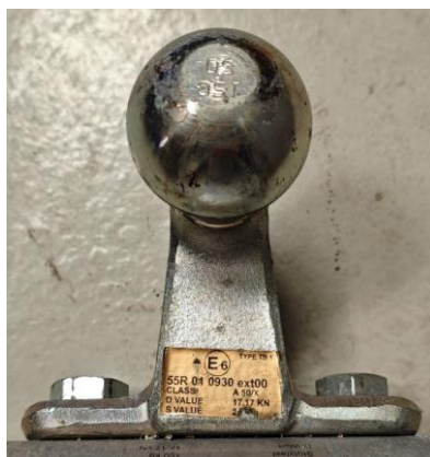
Abb. 13: Kugelkopf mit E-Prüfzeichen
