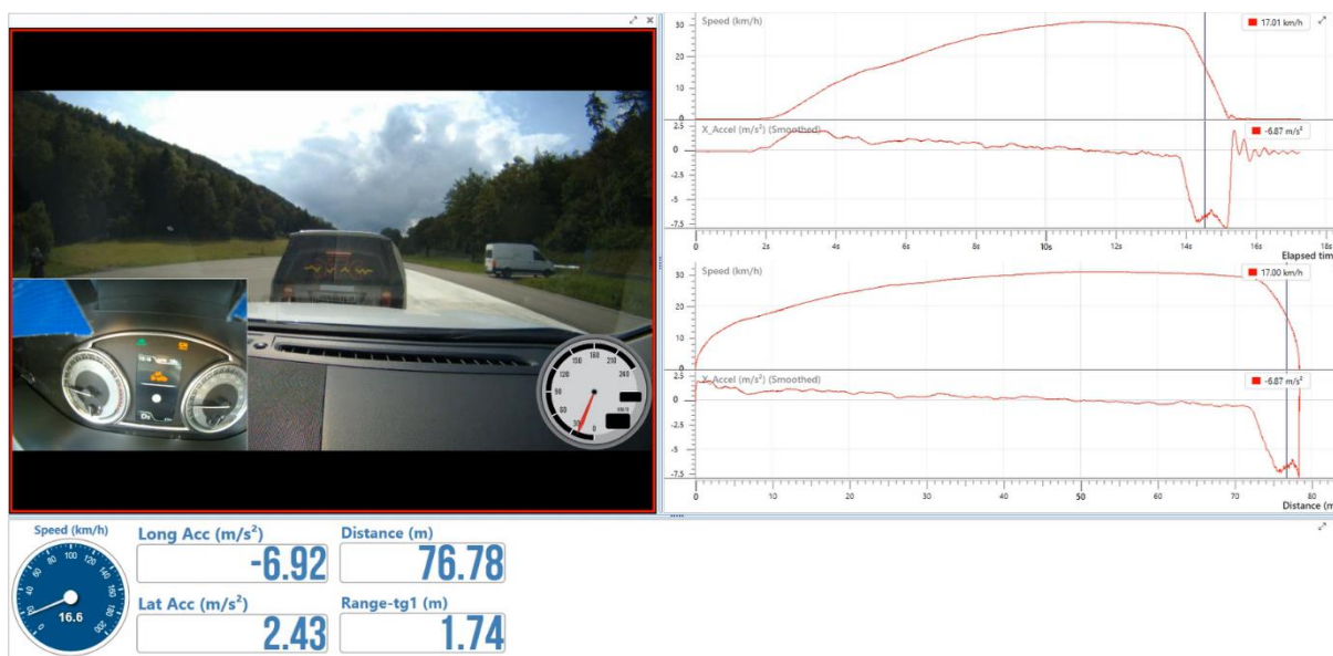
Abb. 17: automatisch eingeleitete Notbremsung aus 30 km/h auf \mu -Split
