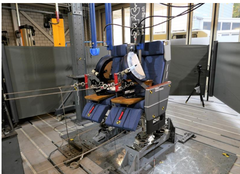
Abb. 15: Quasistatischer Zugversuch bei einem Flugzeugsitz
