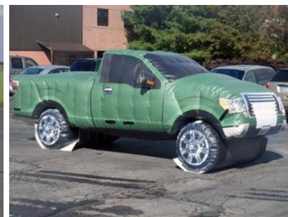
Abb. 13: Aufblasbares Target Quelle: www.moshondata.com/en/3d-targets
