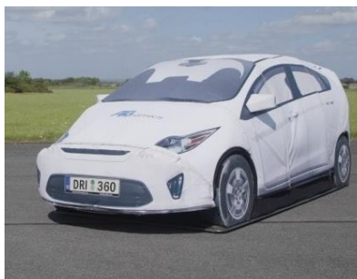
Abb. 12: Guided Soft Target (AB Dynamics) Quelle: www.abdynamics.com
