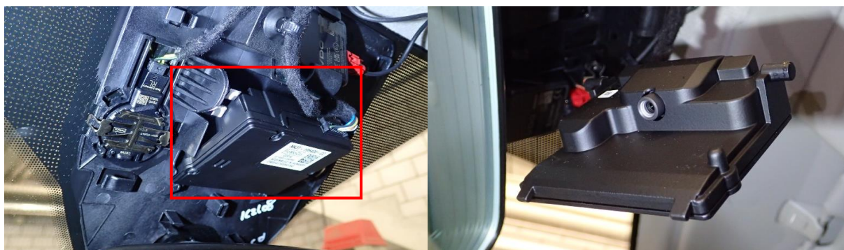
Abb. 4: Spurhaltewarnsystem (Ford Transit 350) hinter Frontscheibe
