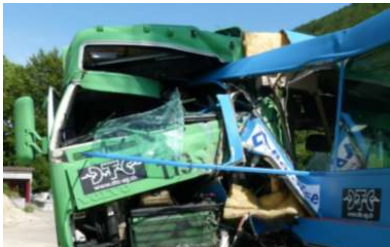
Abb.pSi 10 Intrusionen in das Fahrerhaus
