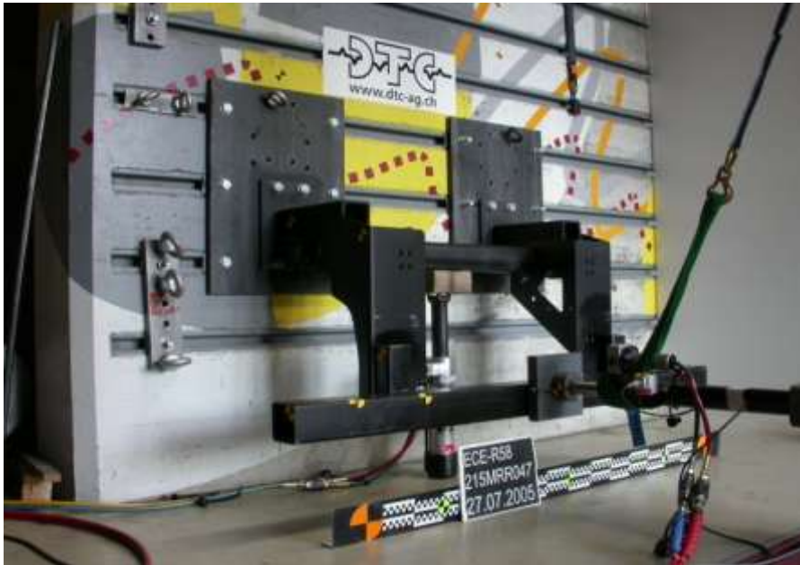
Abb. EnS 1: Versuchsaufbau eines quasistatischen Druckversuches nach ECE R58
