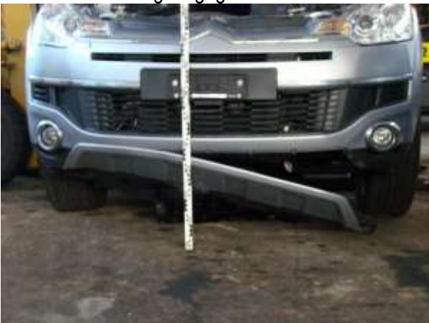
Abb. DUA 1: Frontansicht des Fahrzeugs mit abgerissener Verschalung – kaum Beschädigungen im Frontbereich
