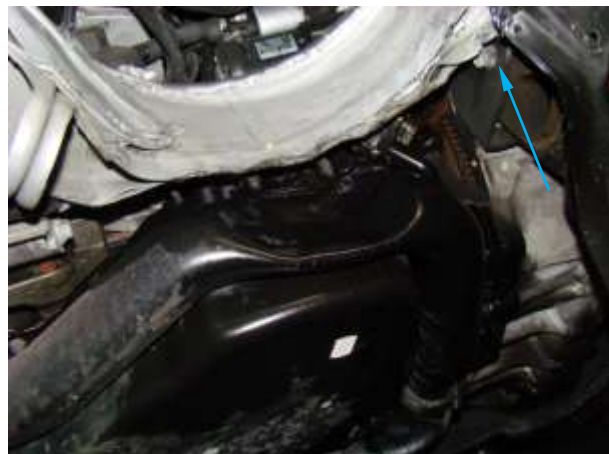
Abb. DUA 2: Deformation am Vorderachsträger – massive Beschädigung an der Vorderachse; der Pfeil zeigt die Fahrtrichtung an
