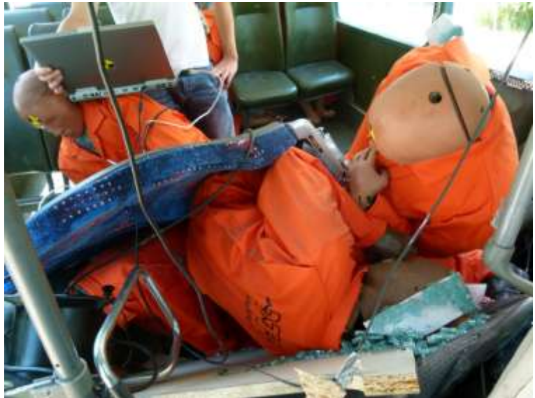
Abb.pSi 16 Angegurtete Dummies auf ausgerissemem Sitz
