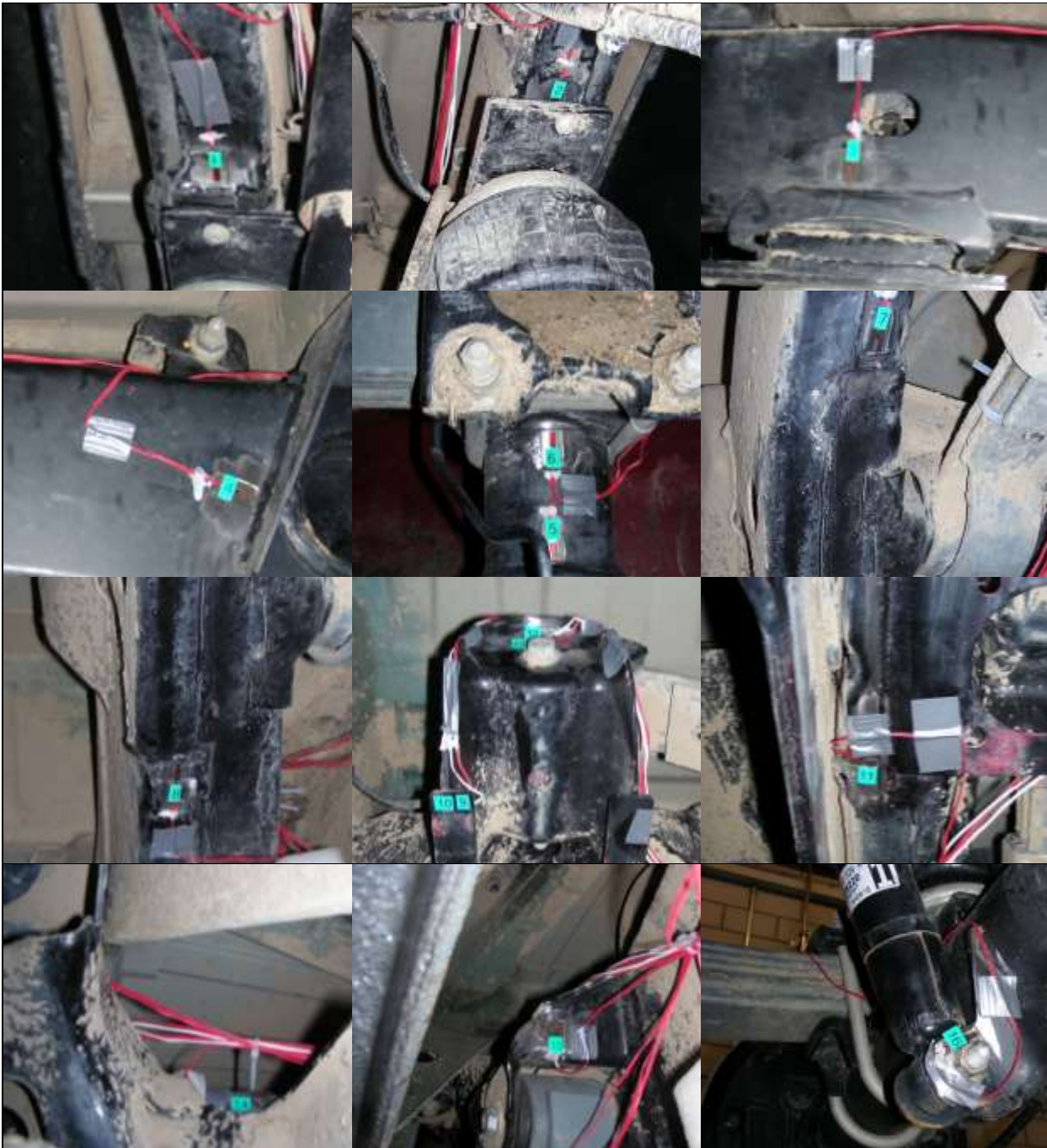
Abb. aSi 4: Lage der applizierten Dehnungsmessstreifen
