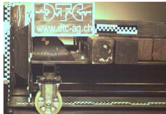
Abb.3: maximale Deformation der Crashbox aus EPP-Schaum (Expandierbares PolyPropylen, ist ein Baustoff, der dem bekannten Styropor sehr nahe kommt.)
