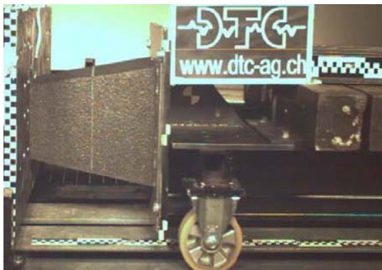
Abb. 2: Der Favorit an dem 300 kg Prüfwagen bei Erstkontakt
