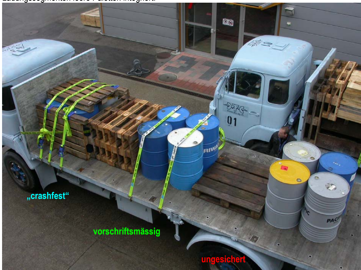
Abb. Drei unterschiedlich gesicherte Fasspakete
