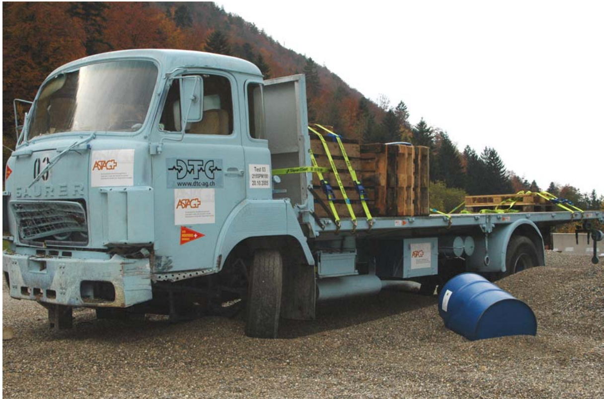
Abb.: Auf der Ladebrücke bleibt nur noch die „crashfest“ gesicherte Ladung
