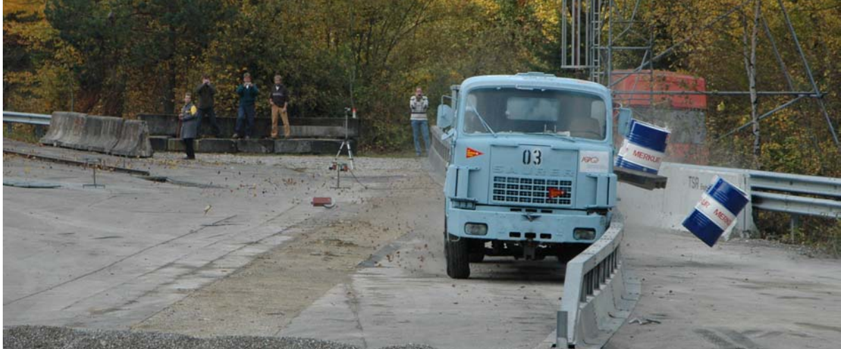
Abb.: Ungesicherte Ladung wird auf die Gegenfahrbahn geschleudert
