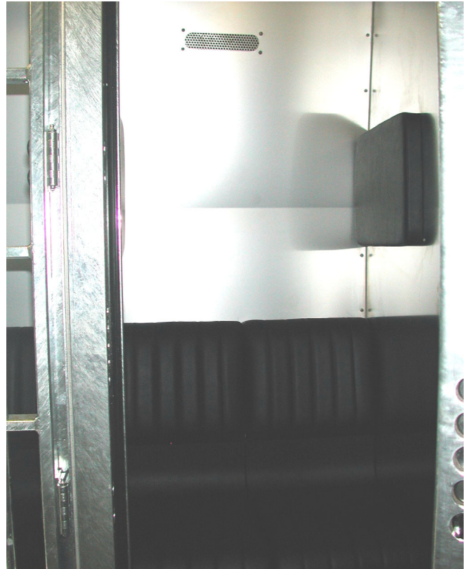
Abb. 3 Einzelzelle bei geöffneter Tür mit längsgerichteter Sitzbank und seitlichen Kopfkissen.
