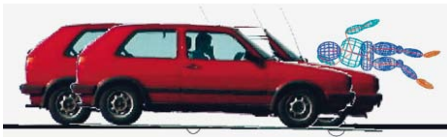
Simulation d'un accident avec piéton par le système multicorps
