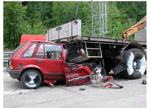
Bildvorschlag „Crashtest Pw mit 100 km/h gegen Lastwagen mit Unterfahrschutz“ (unterfahrschutz\mit unterfahrschutz\fotos\nach kollision\DSCN6241.JPG)
