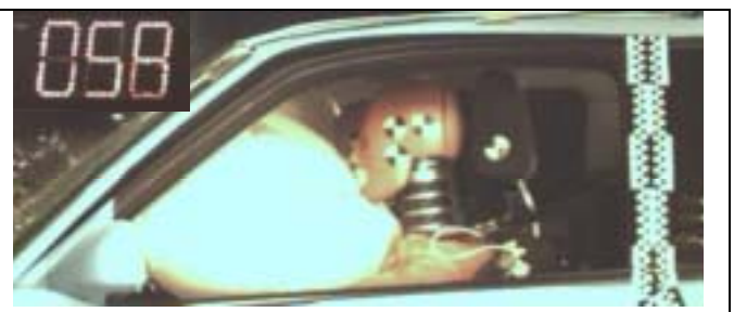
Abb. 25 Zeitpunkt der Berührung von Kinn auf Airbag.
