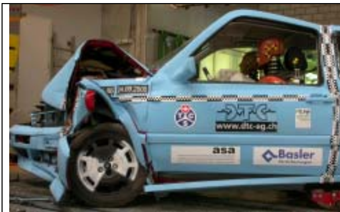
Abb. 11 Seitenansicht Golf nach dem Versuch.
