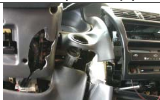
Abb. 52 Zerstörte Verschaltung des Zündschloss.
