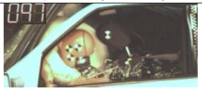
Abb. 46 Zeitpunkt der maximalen Eindringtiefe.
