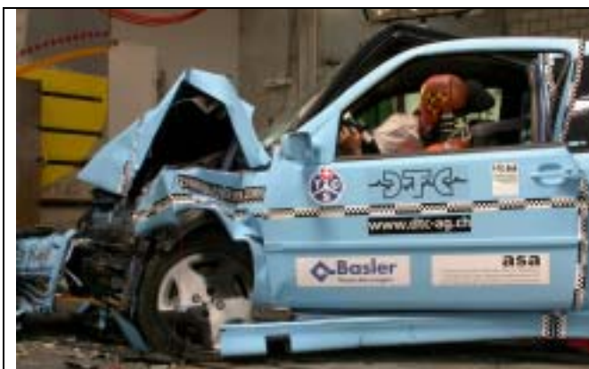
Abb. 37 Seitenansicht des Tipos nach dem Versuch
