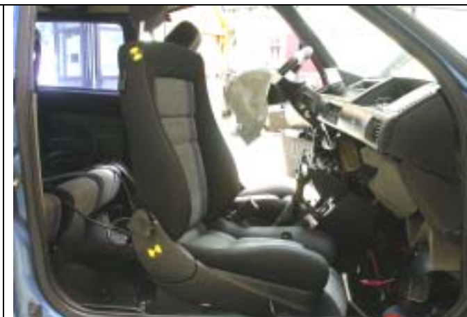
Abb. 40 Deformierter und verdrehter Beifahrersitz.
