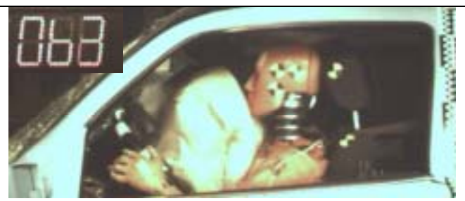
Abb. 44 Zeitpunkt der Berührung von Kinn auf Airbag.
