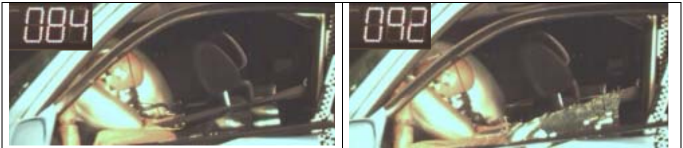
Abb. 55 Zeitpunkt der 3 ms-Spitzenbeschleunigung.
