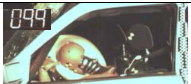
Abb. 36 Zeitpunkt der maximalen Eindringtiefe.
