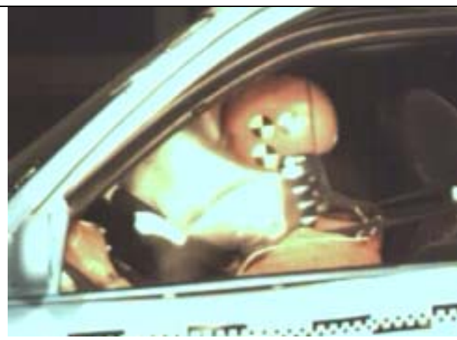
Abb. 50 Dummabrust biegt Lenkrad nach vorne gebogen.
