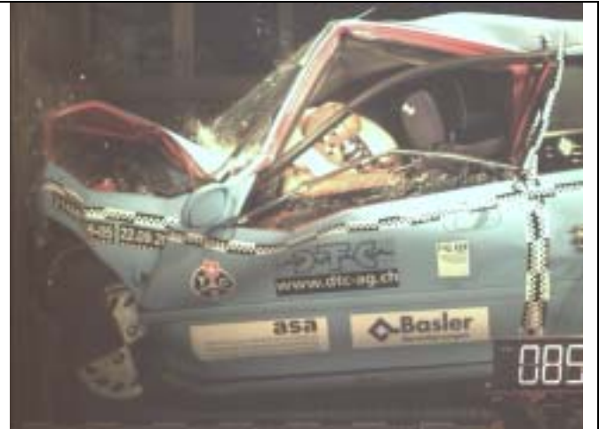
Abb. 60 Fahrzeugdeformation während des aktuellen Versuchs.
