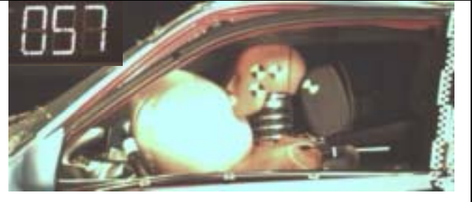
Abb. 64 Zeitpunkt der Berührung von Kinn auf Airbag.
