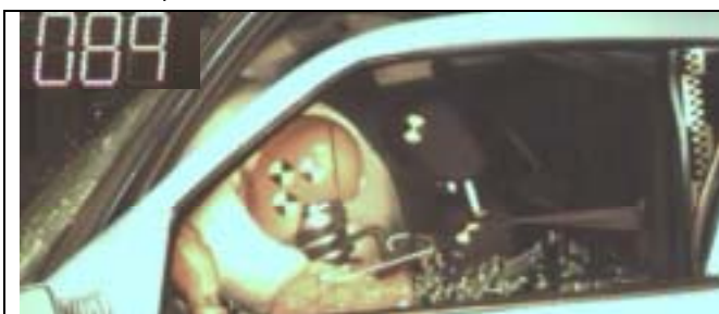
Abb. 45 Zeitpunkt der 3 ms-Spitzenbeschleunigung.
