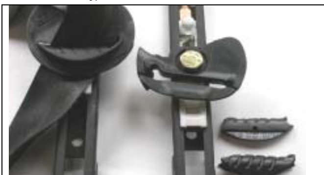
Abb. 15 Fahrer- und beifahrerseitigen Umlenkbeschläge.
