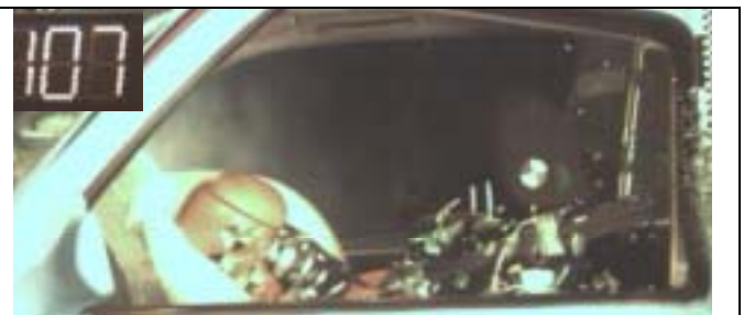
Abb. 20 Zeitpunkt der maximalen Eindringtiefe.
