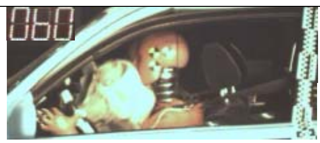
Abb. 54 Zeitpunkt der Berührung von Kinn auf Airbag.
