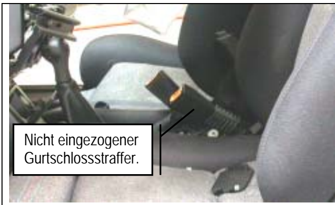
Abb. 41 Gurtschlosspeitsche nach dem Versuch.
