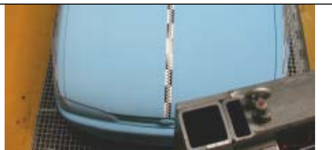
Abb. 6 50 % Überdeckung, Ansicht von vorne.
