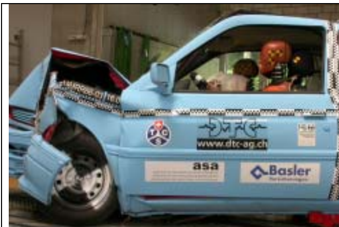
Abb. 28 Seitenansicht Escort nach dem Versuch.
