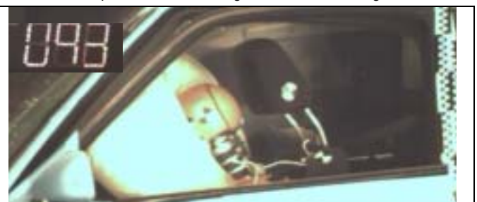
Abb. 27 Zeitpunkt der maximalen Eindringtiefe.
