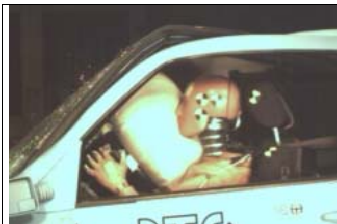
Abb. 31 Lenkrad dringt in den Innenraum.
