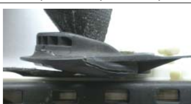
Abb. 16 Riss in der Ummantelung fahrerseitig.
