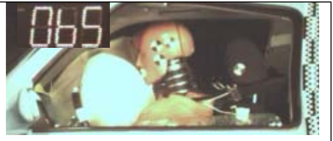
Abb. 18 Zeitpunkt der Berührung von Kinn auf Airbag.
